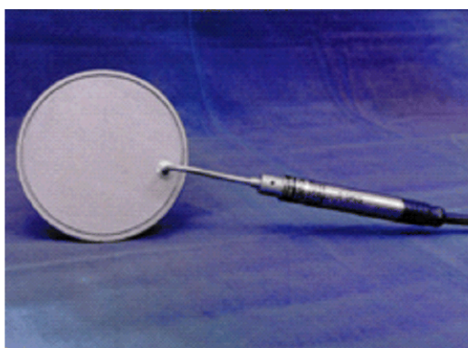
Cella di pressione totale per terreni, con trasduttore elettrico a corda vibrante
